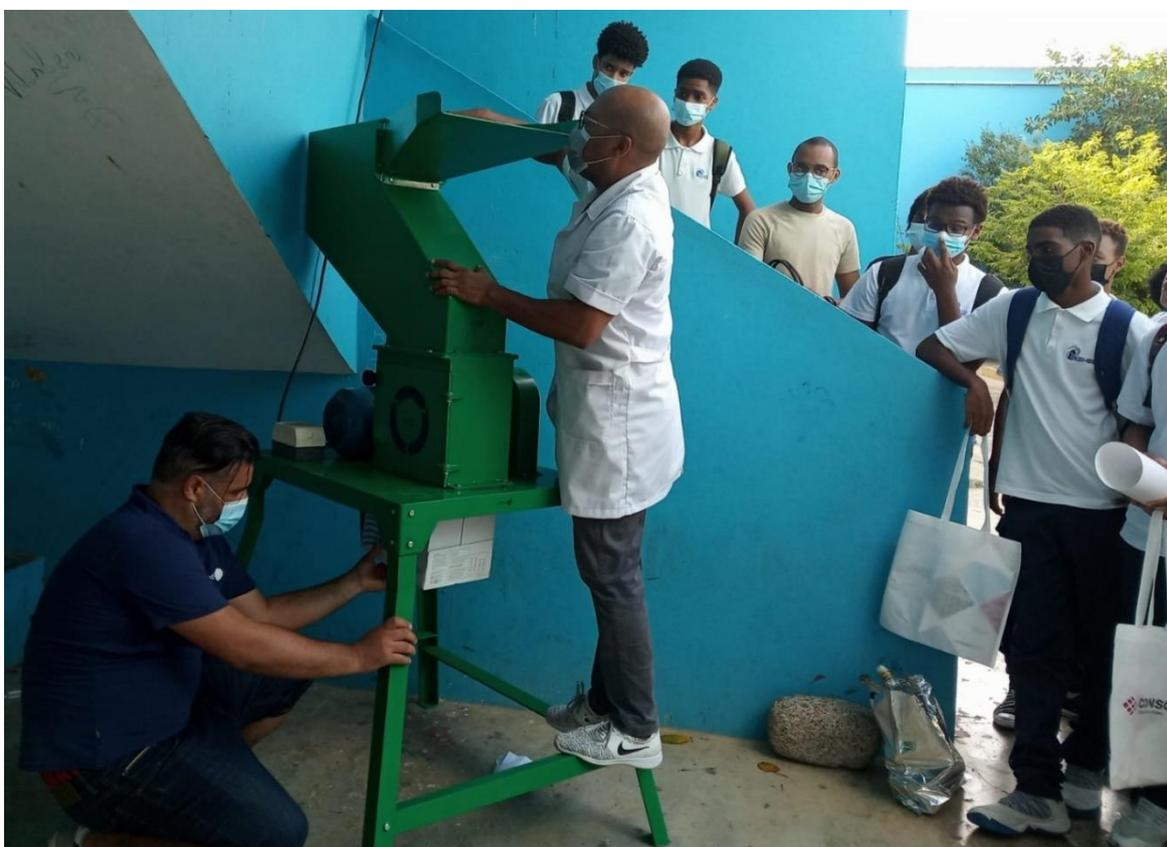
Ilustração 9: Instalação de uma máquina de trituração do vidro, de fabrico local, para a Oficina de reciclagem de Vidro, na EICM Escola Industrial e Comercial do Mindelo
