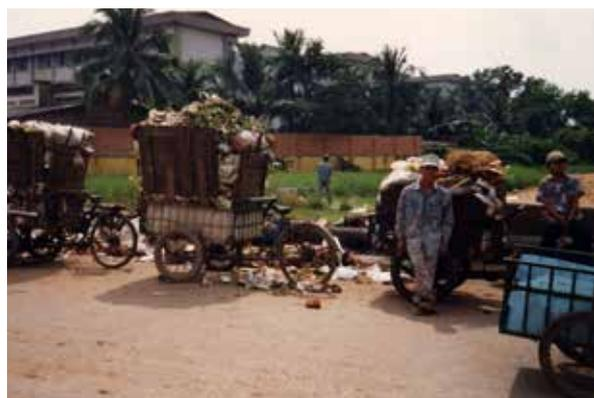
a) A carga em frente do operador impede a visibilidade
