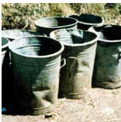
e) Latas do lixo galvanizadas de espessura reduzida danificam-se facilmente
