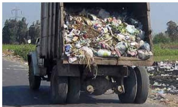
**Foto 7.20 Quando o mecanismo de compactação não pode ser reparado, ele pode ser retirado.**
