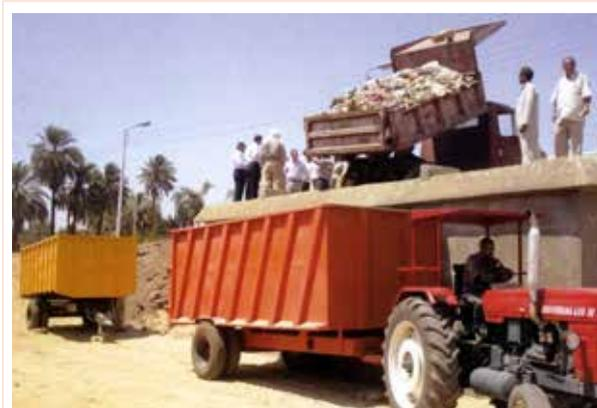
*Note o tamanho dos reboques, a presença do reboque de reserva, e a saliência para assegurar que não caiam resíduos entre a parede e o reboque. Para pequenas distâncias de transporte (até 20 km) tractores com estes grandes reboques são mais eficientes do que camiões.*
