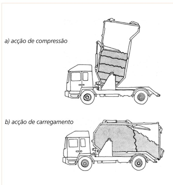
Figura 7.19 Uma variante de carroçaria basculante para a frente e para trás (figura 7.15), com placa de compressão para alguma compactação.
