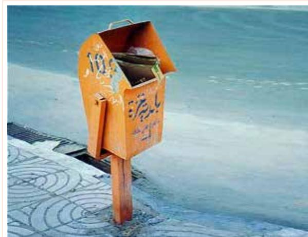
Foto 6.2 Caixote do lixo de pequenas dimensões giratório que pode ser esvaziado por inclinação.
