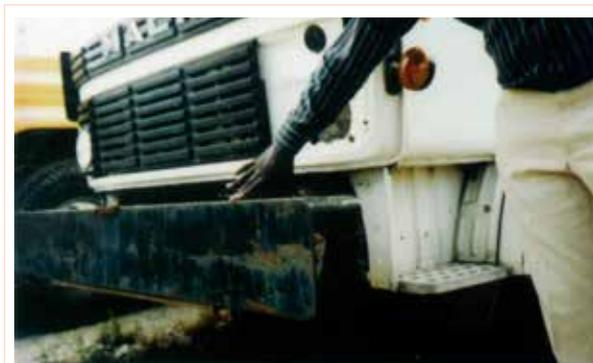
*Este camião foi equipado com uma pequena carroçaria devido à alta densidade dos resíduos na Colômbia. Foi então necessária uma tonelada de balastro na parte frontal para evitar que caísse para trás no descarregamento, reduzindo ainda mais a sua capacidade de carga.*
