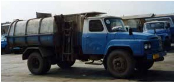
Figura 7.16 e Foto 7.14 Camião não compactador com elevador de contentores.
