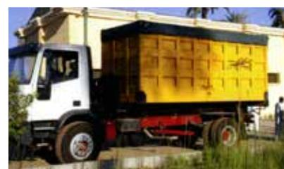
c) Contentor num veículo de transporte basculante especialmente desenhado. Capacidade do contentor correspondendo à densidade dos resíduos e à classificação da carga do camião
