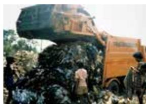
b) O lixo é empurrado hidraulicamente pela placa de compressão (ou ejector)
