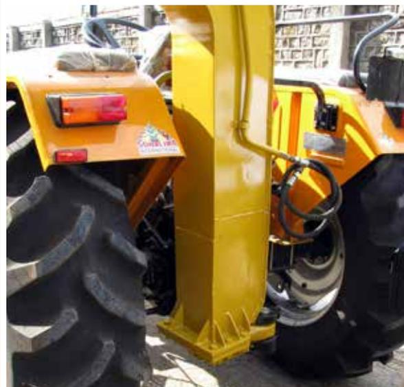
c) Deve haver espaço livre suficiente entre a barra de tracção e as rodas do tractor para permitir o uso num piso irregular
