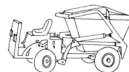
Figura 7.36 Sistema de contentor baseado num *dumper* de estaleiro de construção.
