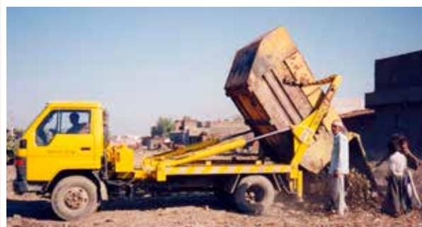
**Foto 7.27 Veículo de elevação de contentores skip descarregando.**
