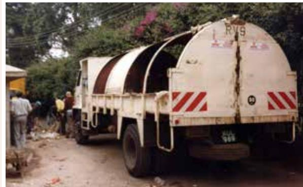
Figura 7.13 e Foto 7.12 Veículo de recolha de caixa semi-cilíndrica (carregamento lateral).
