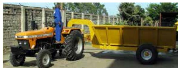
a) Este modelo permite uma maior capacidade e um mais fácil carregamento, e a barra de tracção de pescoço de cisne permite uma maior manobrabilidade
